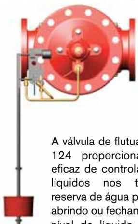
A válvula de flutuador da série 124 proporciona um meio eficaz de controlar o nível de líquidos nos tanques de reserva de água para incêndio, abrindo ou fechando quando o nível de líquido atinge seus pontos baixos e altos pré-estabelecidos.
