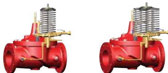
A válvula de altitude da série 210 é normalmente usada em reservatórios onde a água é retirada por uma linha separada ou por meio de uma linha de desvio. A válvula se abre para encher o reservatório quando a água atinge um ponto abaixo do nível pré-estabelecido de fechamento. Ela é disponibilizada em uma série de configurações, incluindo aquelas projetadas para um fluxo de via única e para combinação de controle de altitude e pressão de retorno.
