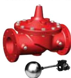
A válvula de flutuador da série 129 de alta precisão mantém um nível consistente nos tanques de armazenamento e reservatórios de diâmetro grande por meio da admissão de fluxo dentro do tanque em proporção direta ao fluxo fora do tanque.
